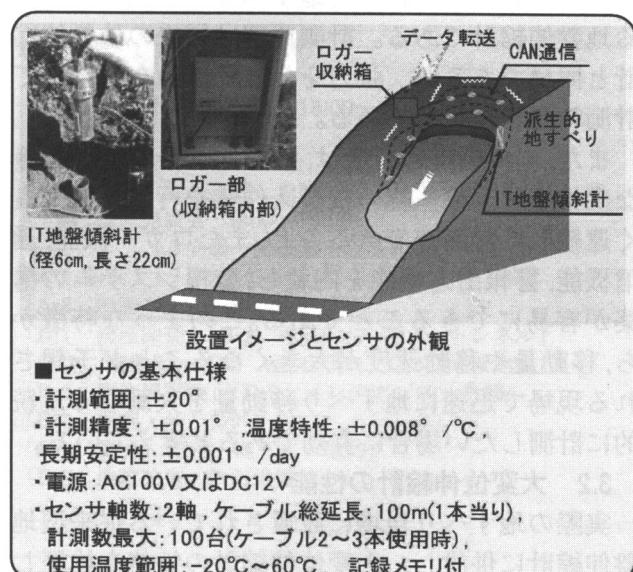
図2 IT 地盤傾斜計測システム概要図
