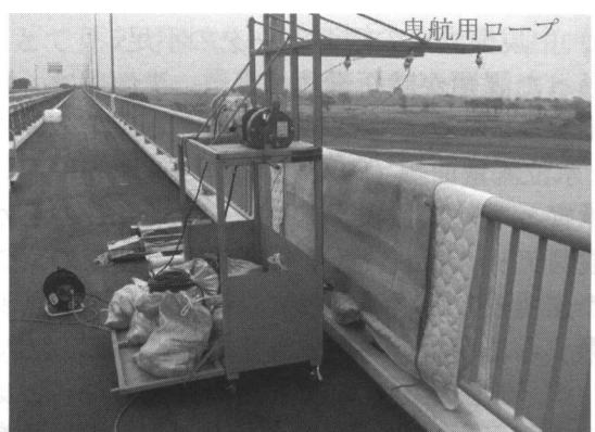
図 4 ADCP 搭載ボートを係留・曳航するための移動式観測架台の例
