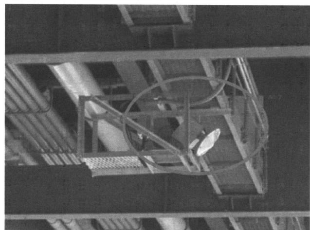
図8 橋桁下に固定設置した電波流速計
