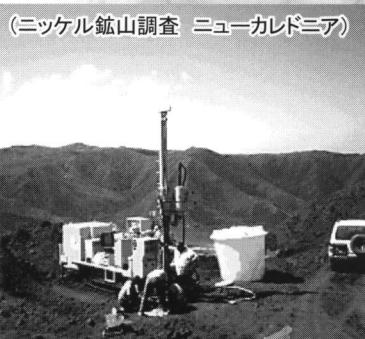
ワイヤーライン工法用削孔機
