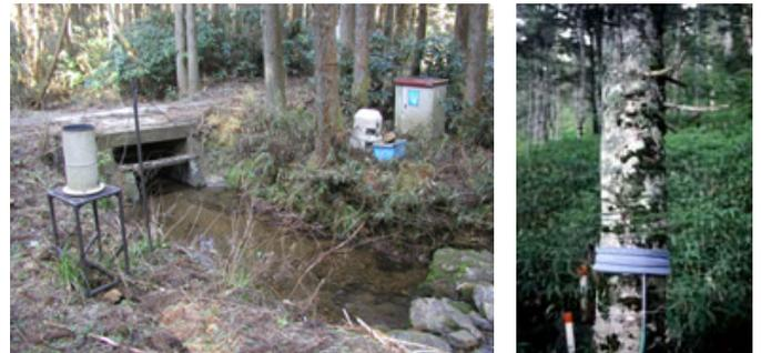
図4 水質観測点における降雨・渓流水の採取(左)と樹幹流の採取(右)(森林総合研究所 HP)
