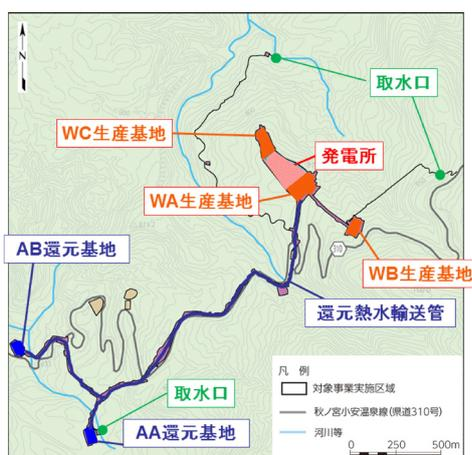
図-4 発電設備および生産・還元設備の配置計画<sup>3)</sup>
