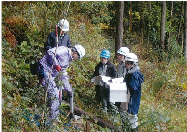
写真-1 (2) 孔内傾斜計観測の指導を受けている様子
