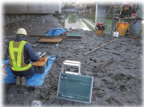
写真2 現場で孔内試験を実施中
