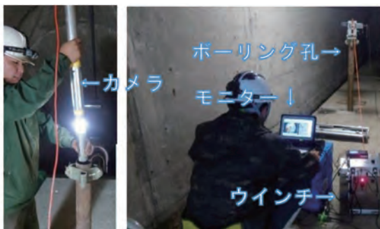
図-1 ダム内でのボアホールカメラ撮影の様子
