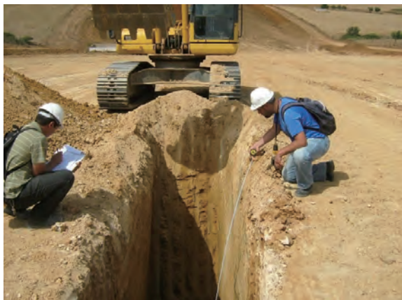
写真2 盛土材料の試掘調査
