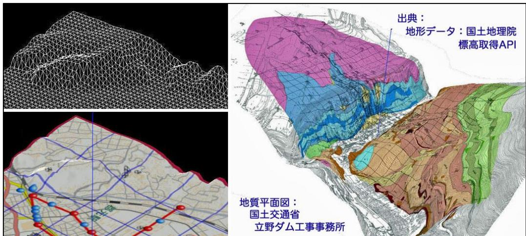
(左上) ワイヤーフレーム、(左下) 地形図を付加したモデル、(右) 地質図を付加したモデル
