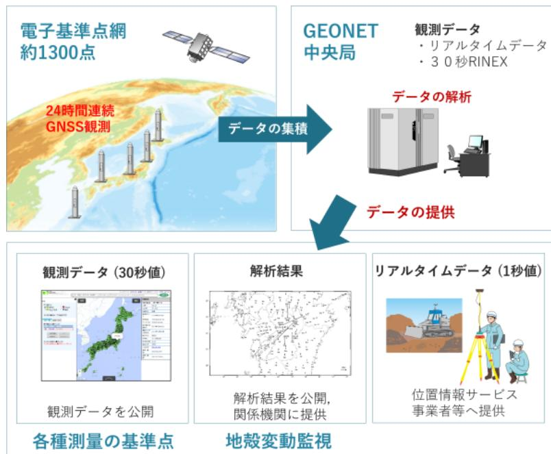
図 2-6 GEONET (GNSS 連続観測システム)
