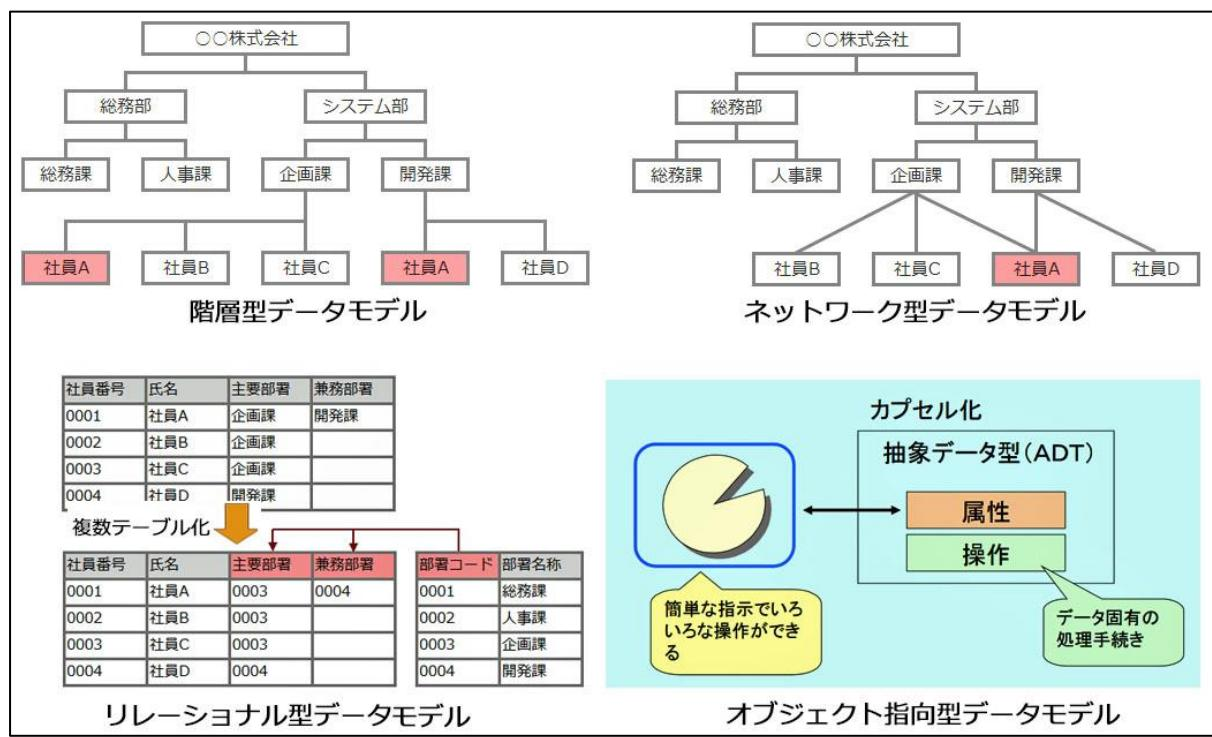
図1-3 データベース（データモデル）の種類
