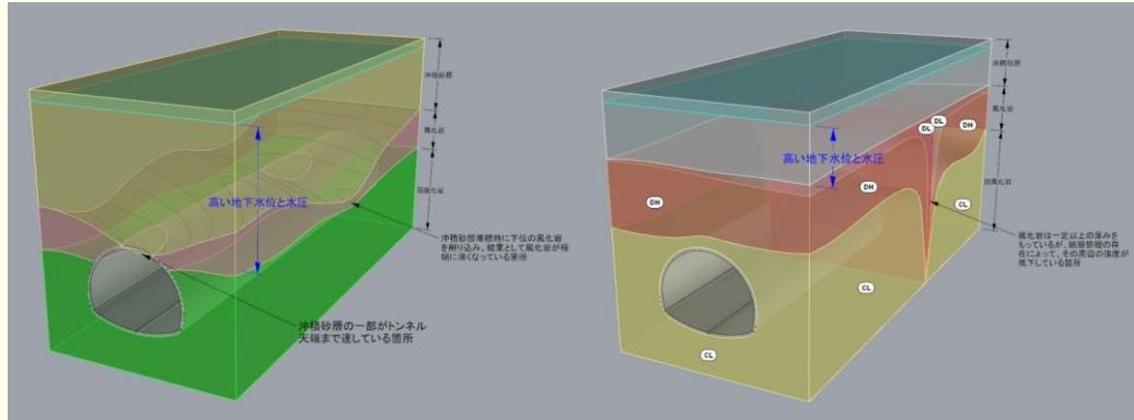
図 4-12 トンネルの地質リスクの可視化（例）
