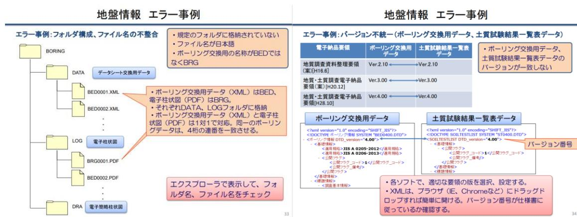
図 4-6 地盤情報のエラー事例（抜粋）
