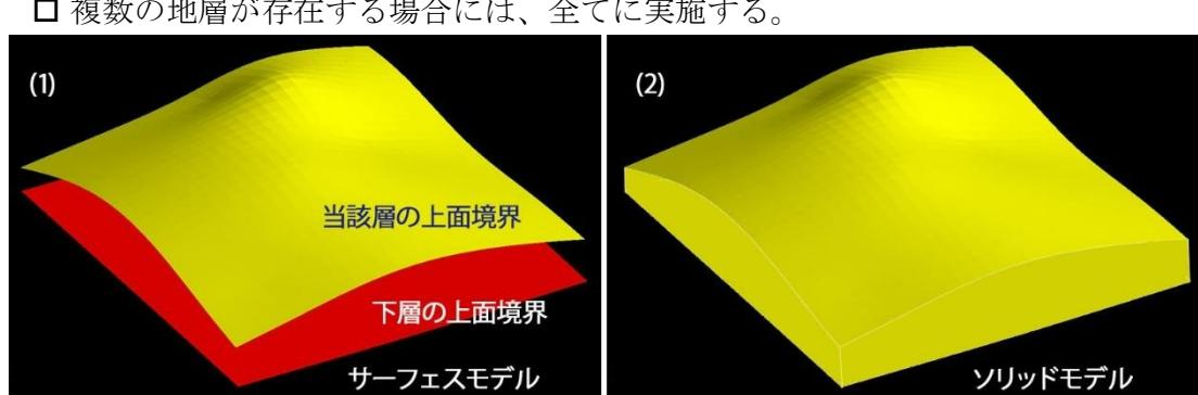
図 6-9 ソリッドモデル (B-reps) の例
