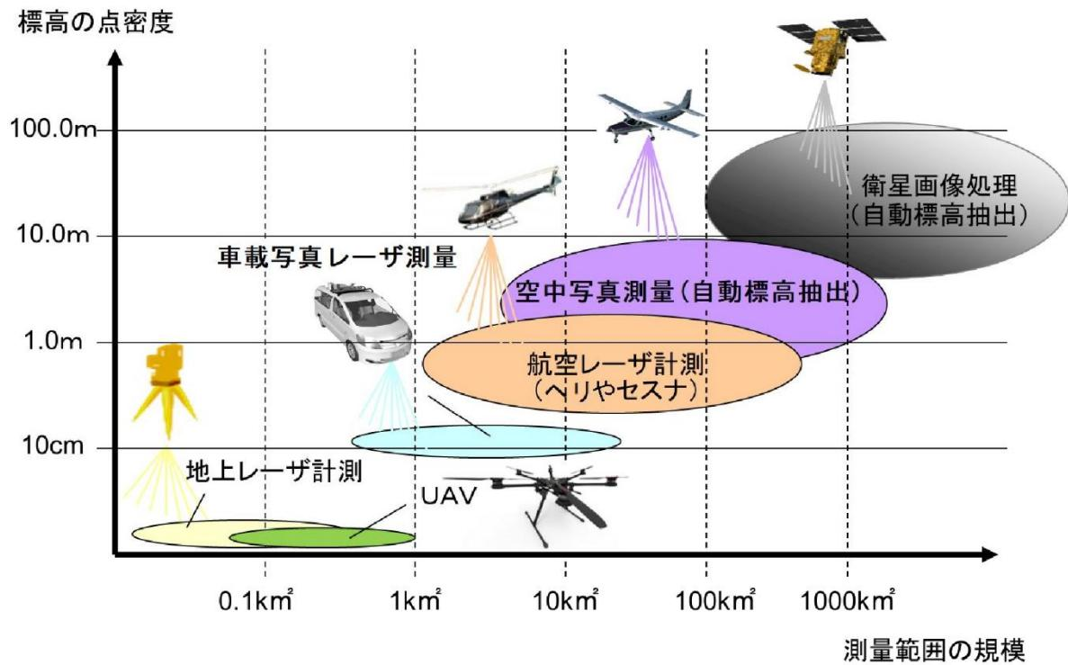
図 2-7 3次元測量手法の点密度と適用範囲
