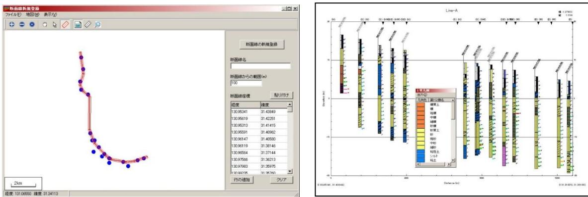
図 4-3 ボーリング柱状図解析システムを使用して断面線沿いの柱状図を表示した例
