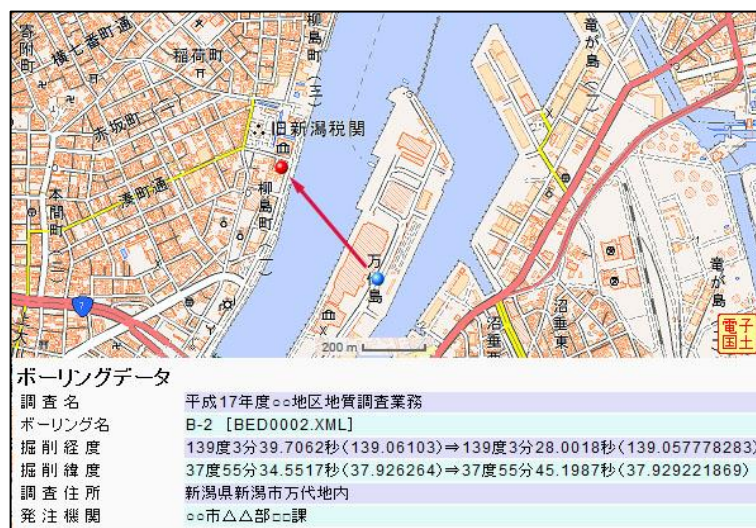
図-3.3 旧測地系による位置情報から新測地系による位置情報に変換処理した例
