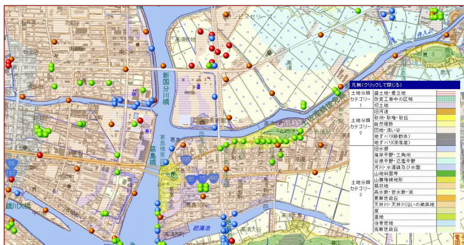
図-6.19 表層地盤モデルを作成する際に使用する土地条件図の例
