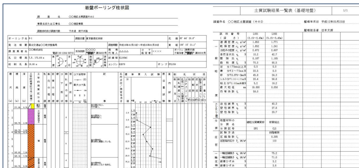
(左) ボーリング交換用データ (XML : DTD400) を柱状図ビューアで図化した例 (左) 土質試験結果一覧表データ (XML : DTD400) を柱状図ビューアで図化した例 ボーリング交換用データの内容確認ツール (1)
