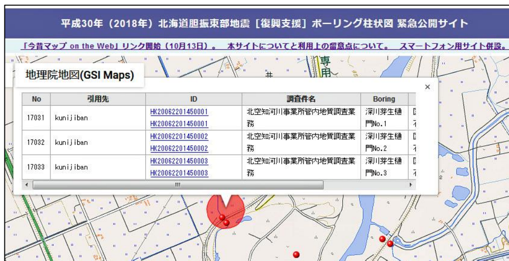
図-2.8 半径約 100m のバッファ内の全ボーリングを抽出した例 (サイト閉鎖)
