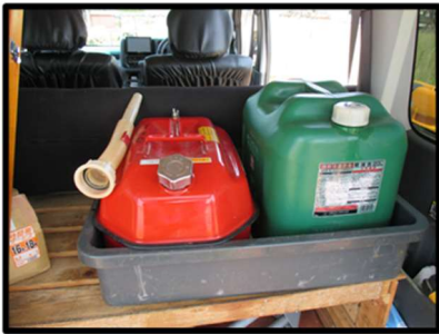
作業現場の燃料缶 保管状況
