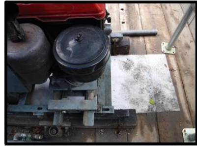
ディーゼルエンジン下部への 油吸着材の敷設状況
