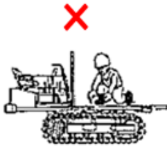
積載資材の中抜き禁止
